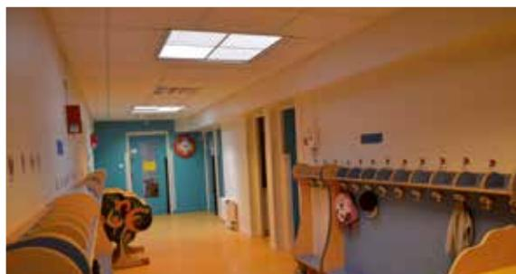
■ Cet été, les travaux se sont multipliés dans les écoles, aux Semailles, aux Alagniers et aux Charmilles, où le renouvellement de l'éclairage et le passage au 100 % leds avec détection de circulation a été installé pour réduire les dépenses d'énergie.
